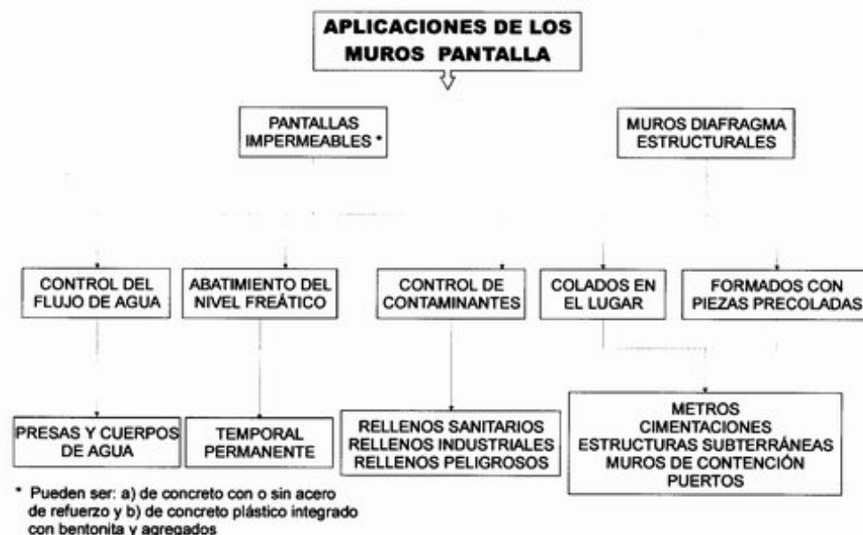
Fig. 3.1, Campos de aplicación de los muros diafragma
