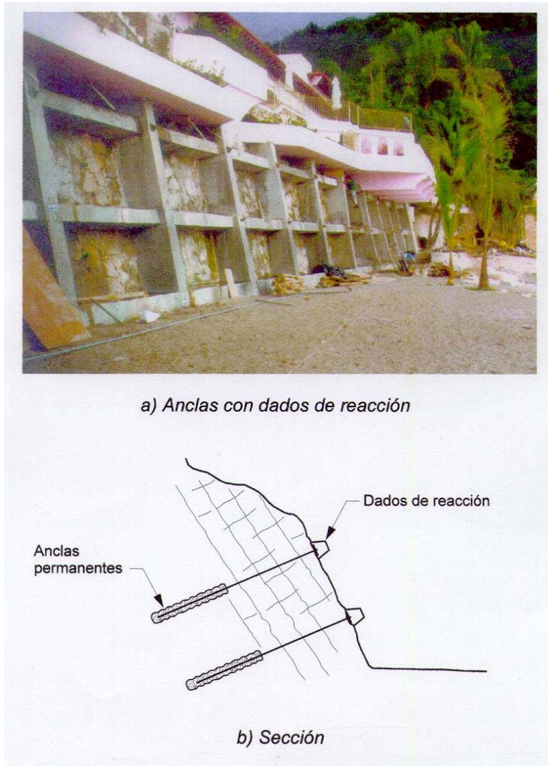
Fig. 5.8, Anclas con dados de reacción en un macizo rocoso
