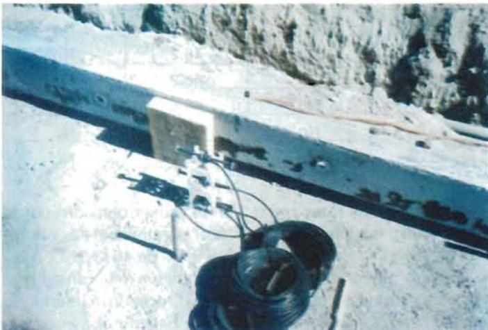
Fotografía 6.16 Dispositivos para medir desplazamientos horizontales en las losas.
