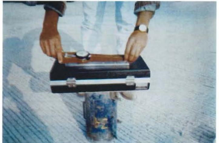
Fotografía 6.17 Ejemplo de dispositivo de medición de movimientos horizontales en juntas.
