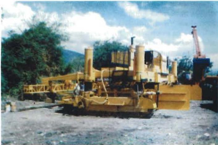
Fotografía 6.7 Equipo de pavimentación. En la parte izquierda de la toma se localiza la parte posterior, donde se realiza la inserción de varillas de sujeción y el aplanado.
