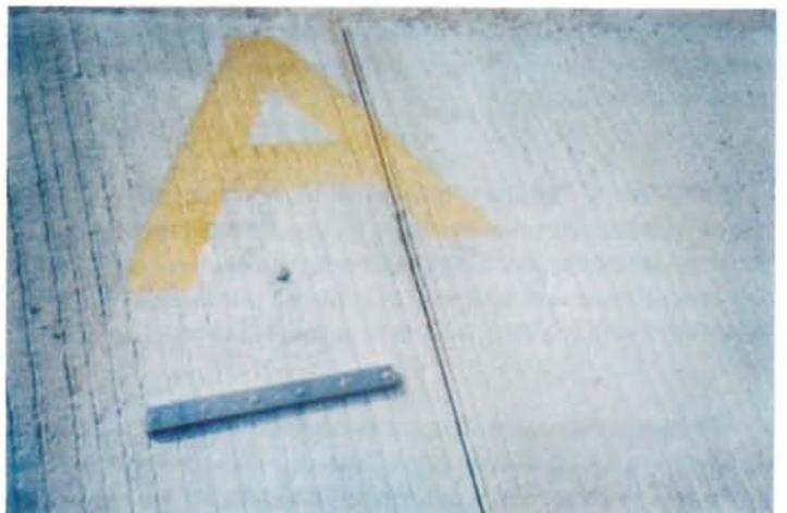
Fotografía 6.18 Puntos de medición de desplazamientos horizontales en juntas.
