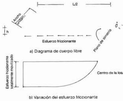
Figura 7.10 Desarrollo de esfuerzo debido a fricción
