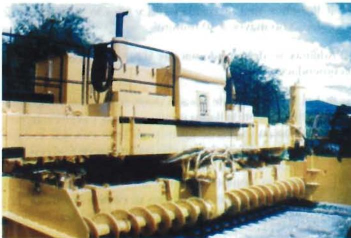
Fotografía 6.6 Vista frontal del equipo de pavimentación. En la parte inferior se aprecia el tornillo sin fin.
