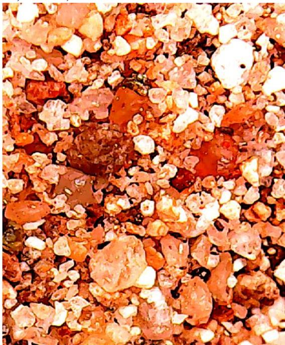
Fig. 21. Arena de la ciudad de Mórrope, Lambayeque, Perú, vista al microscopio. Se aprecian partículas de tamaños variados, colores y formas.
