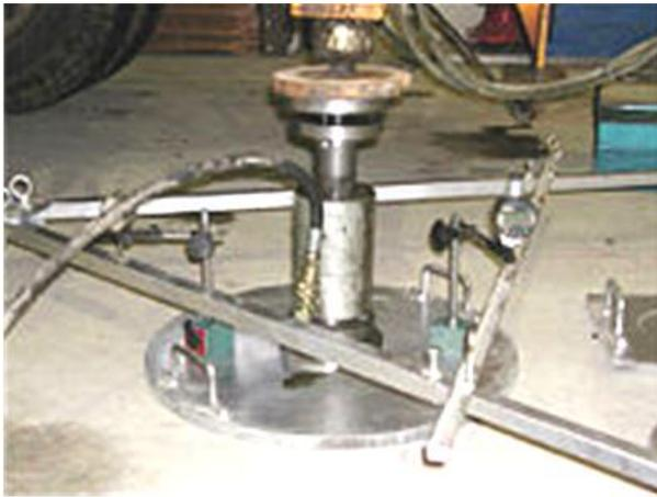
Vista del equipo para el ensayo de placa de carga.
