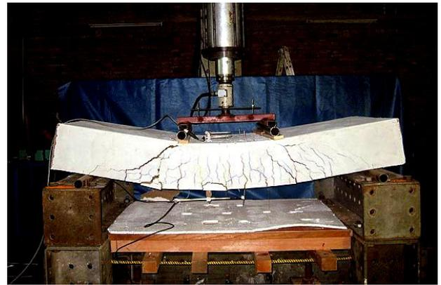
Fig. 11. Falla por flexión de losa. Ensayo en la U. Católica. Perú.
