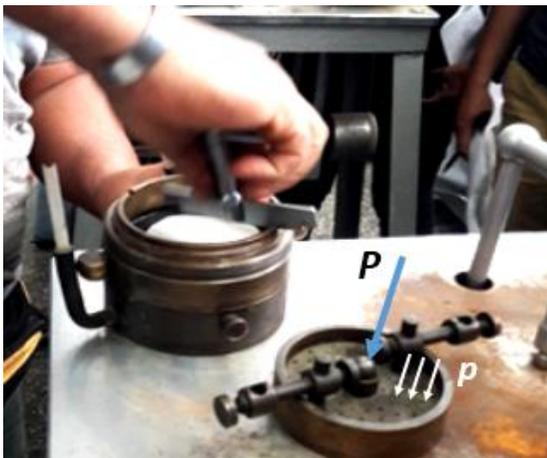
Fig. 7. Armado de la cazuela, en cuyo interior está la muestra de suelo. La muestra tiene papel filtro en ambas superficies. A la derecha figura la placa,
