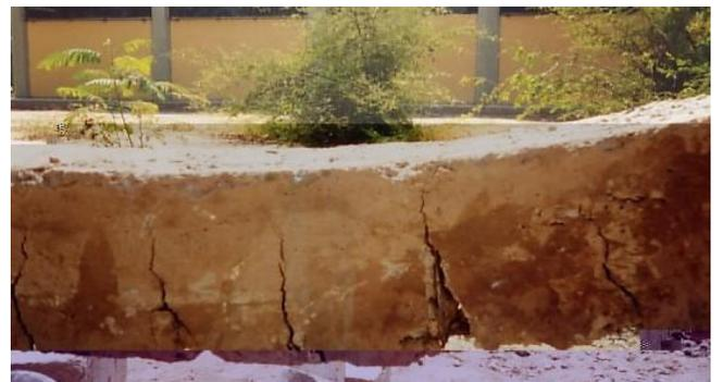
Foto (7). Vista posterior de la viga con las grietas después de la rotura. Como se puede apreciar llegan hasta la zona de compresión del concreto.
