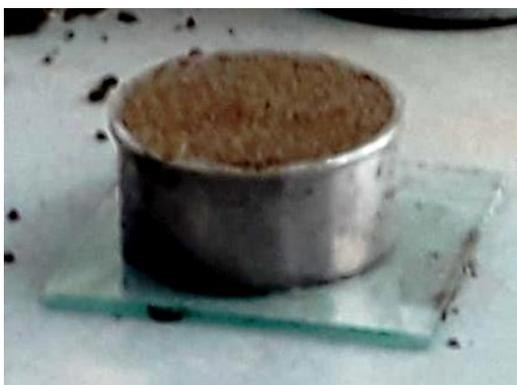
Fig. 15. Muestra tallada dentro de un anillo de dimensiones fijas.
