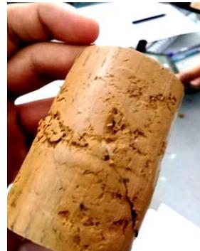
Fig. 10. Forma de falla de la muestra ensayada. Se aprecia una grieta inclinada, concordante con la dirección del esfuerzo cortante máximo.
