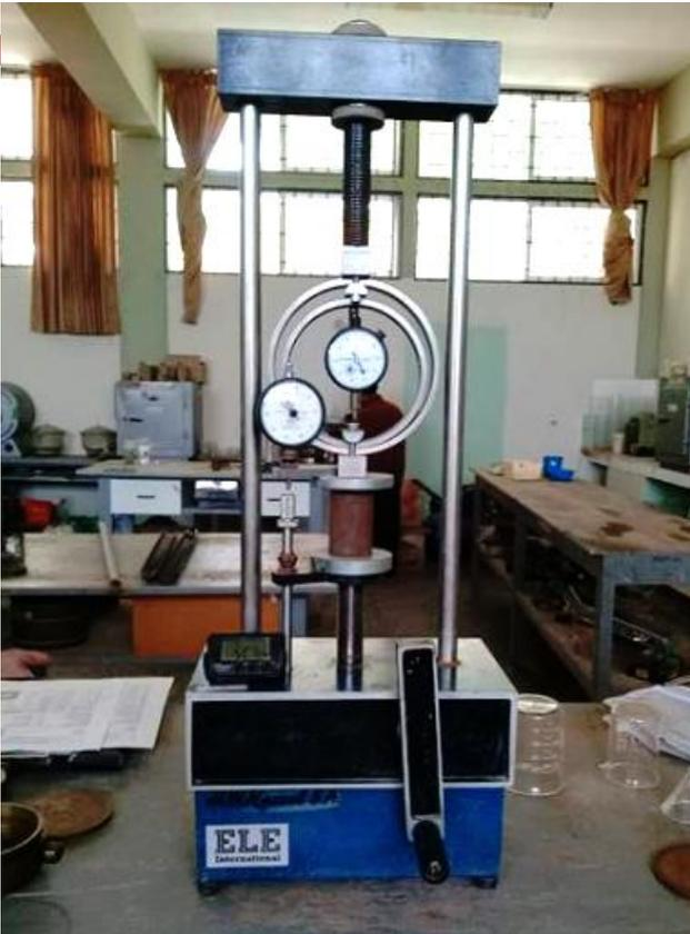
Fig. 5. Máquina de compresión. Se aprecian los anillos de carga, los micrómetros de carga y deformación.
