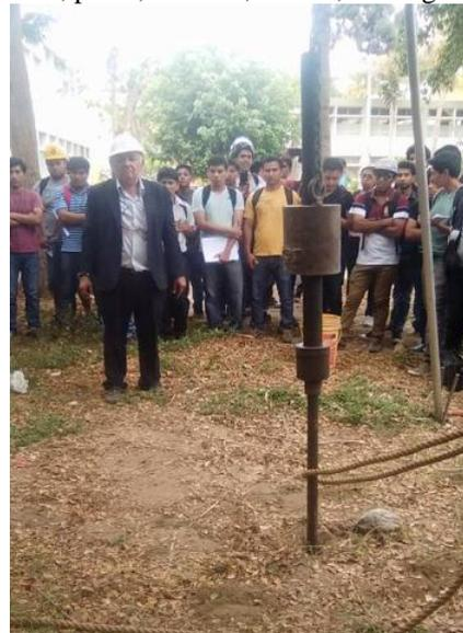
Fig. (6). Colocación del equipo de penetración en el punto de sondeo.
