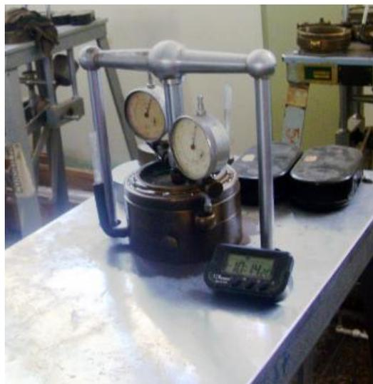
Fig. (3). Consolidómetro o edómetro.
