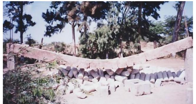
Foto (5). Estado de la Viga después de la falla. El apoyo fijo esta en la izquierda y el apoyo móvil en la derecha.
