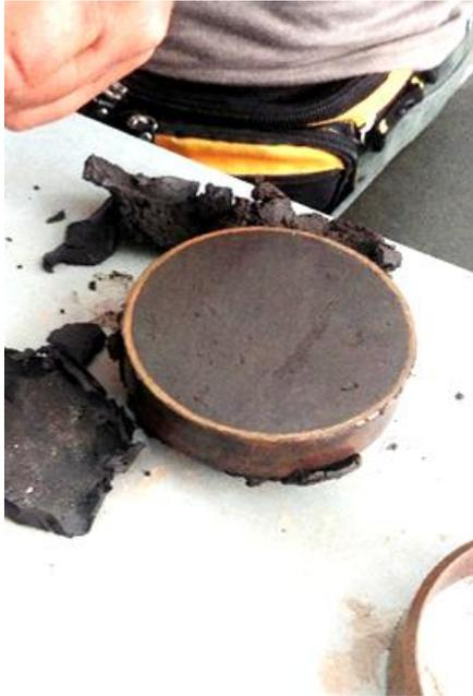
Fig. 6. Tallado de la muestra, usando un anillo metálico, de forma cilíndrico.
