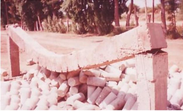
Foto (8). Vista de la Curvatura adoptada por la viga, y levantamiento de la misma en el apoyo móvil.
