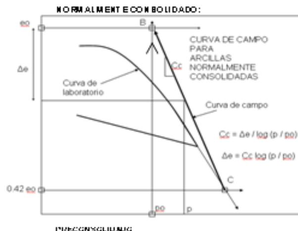
Fig. 34. Método de Schmertman, para determinar la curva de campo, a partir de la curva de compresibilidad, para el caso de  $p_c = p_o$ .
