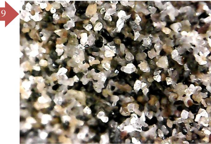
Fig. 3. Arena suelta vista al microscopio.
