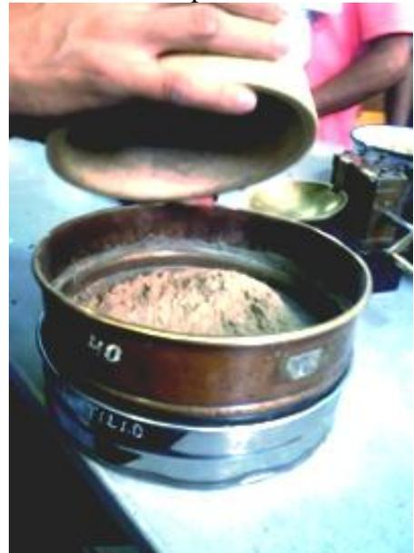
Fig. 52. Los suelos se deben tamizar previamente por la malla Nro. 40, y realizar luego el ensayo al material que atraviesa dicha malla.
