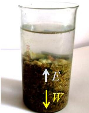
Fig. 9. Fuerzas debidas al peso y al empuje, en un suelo en estado saturado y sumergido.7.
