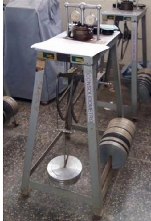
Fig. 5. Consolidómetro. Se observan mesa, cazuela con micrómetros y pesas.
