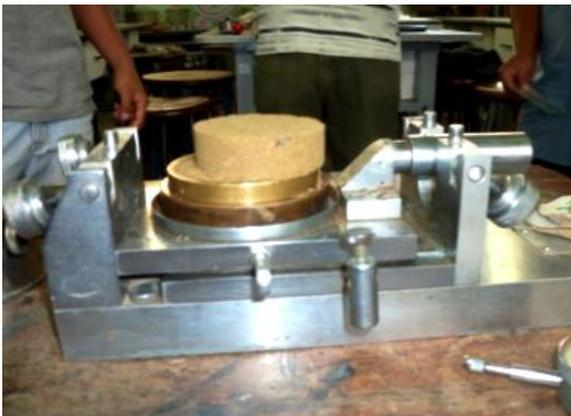
Fig. 7. Muestra arcillosa que ha fallado por
