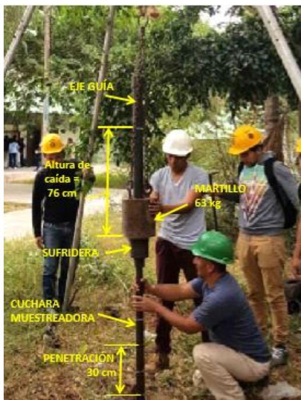
Fig. 2. Detalles del equipo de penetración estándar. El martillo golpea a la caña, a través de un tope llamado sufridera, para que penetre 30 cm. Obra: Muros de contención, en el Malecón Tarapacá, Río Amazonas, Iquitos. Perú.
