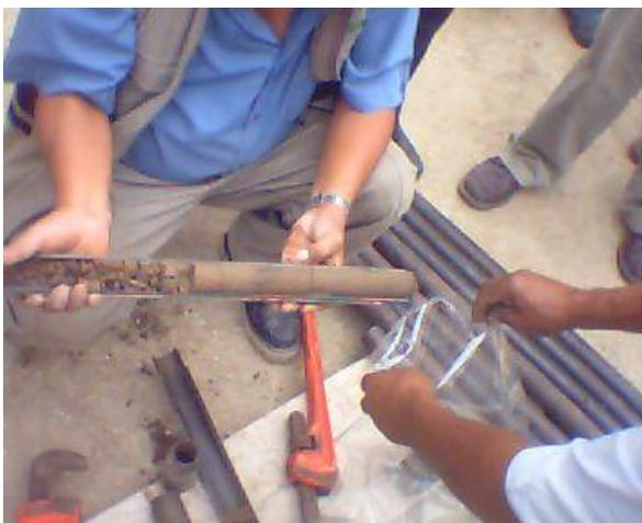
Fig. 4. La caña partida o cuchara, al ser abierta, contiene la muestra de suelo, la que es llevada al laboratorio, para efectuarle ensayos complementarios. Obra: Tanque elevado de Nuevo Mocce.
