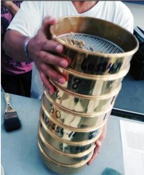
Fig. 24. Tamizado del suelo por todas la mallas.
