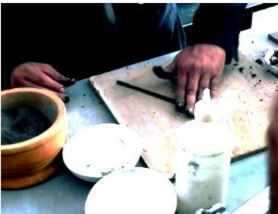
Fig. 55. Materiales usados para el ensayo de límite plástico.
