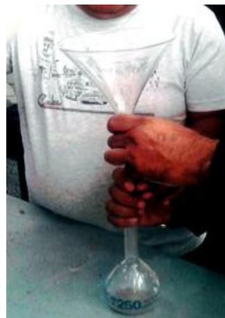
Fig. 18. Colación del suelo seco en la fiola.
