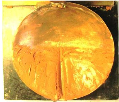
Fig. 50. Ranura hecha a la masa de suelo colocada en la copa de Casagrande.
