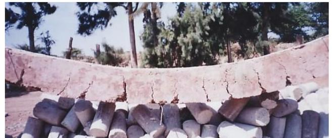
Foto (6). Grietas producidas en la zona central de la viga, después de la falla.
