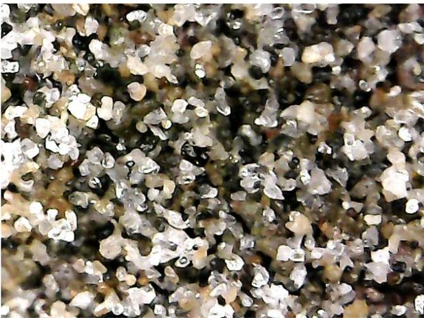
Fig. 4. Arena en estado medio denso vista al microscopio.
