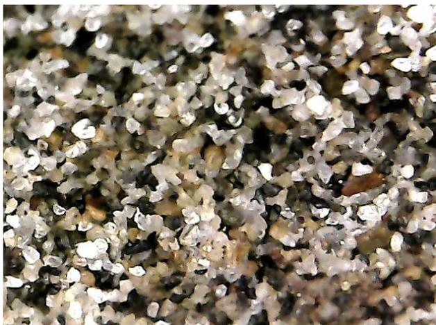
Fig. 5. Arena densa (compactada) vista al microscopio.
