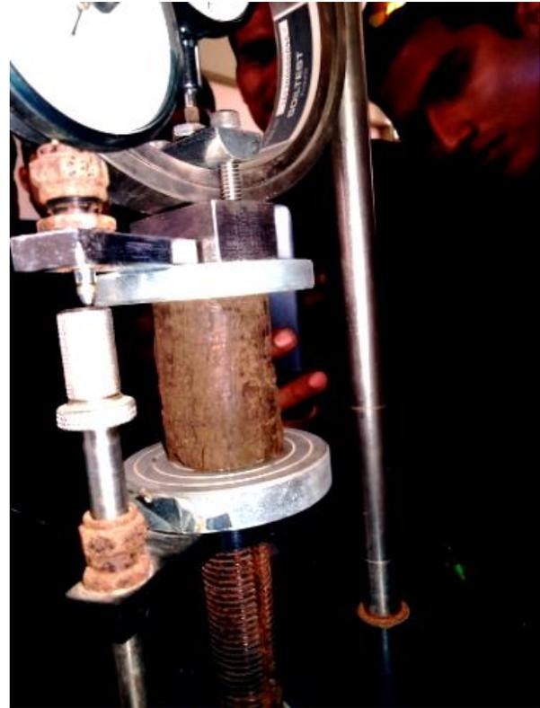
Fig. 9. La muestra en el proceso de cargado.
