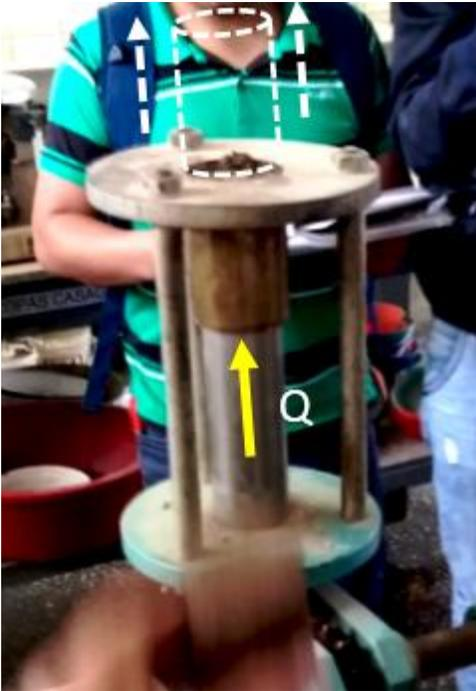
Fig. 7. Extracción de muestra del molde (anillo) en que fue tallado.
