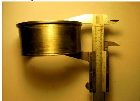
Fig. 13. Vernier o pie de rey, usado para medir el diámetro y altura del anillo.
