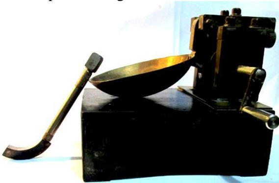
Fig. 46. Copa de Casagrande y ranurador del tipo ASTM, recomendado para arenas con arcillas.
