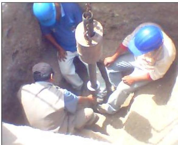
Fig. 3. Vista superior, del martillo que golpea a la sufridera, para introducir la caña o cuchara, dentro del suelo. Obra: Tanque Elevado de Nuevo Mocce.
