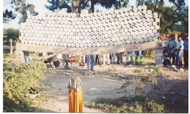
Foto (4). Continuación del proceso de cargado de viga. Se aprecia notablemente la deformación.
