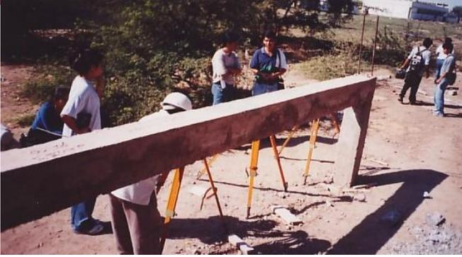
Foto (1). Sistema Viga - Columnas - Zapata - Suelo, con colocación de Trípodes con Micrómetros.
