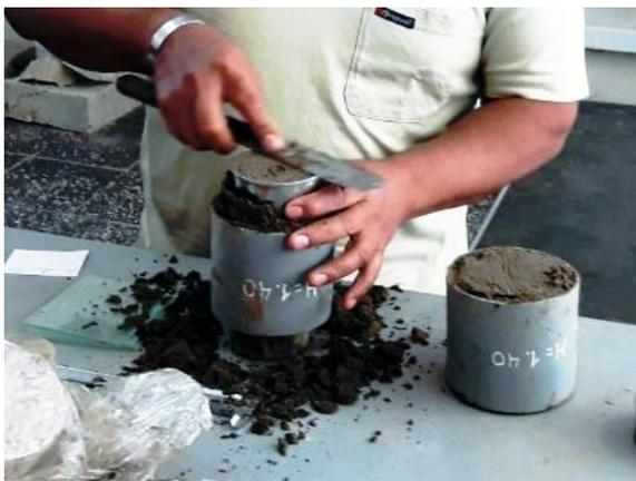
Fig. 14. Tallado de muestra inalterada.
