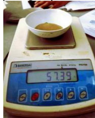
Fig. 27. Pesado del material retenido en una malla.
