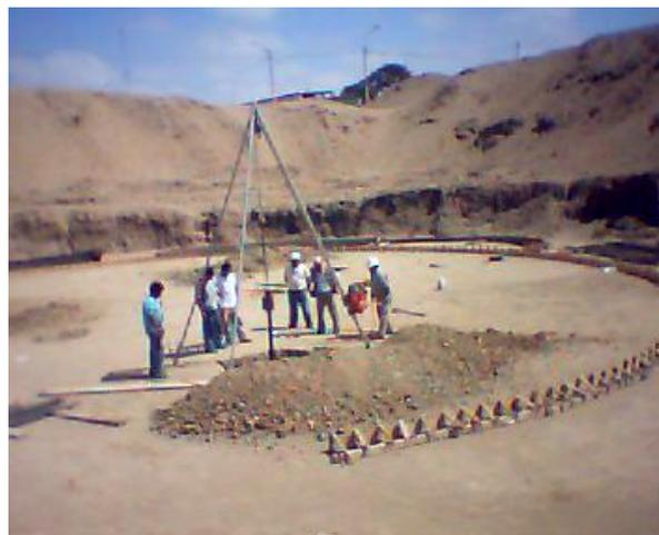
Fig. (1). Ensayo de SPT, para el tanque Nuevo Mocce en Lambayeque.
