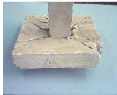
Fig. 3. Falla por punzonamiento. Ensayo efectuado en el Laboratorio de Ensayo de materiales de la UNPRG.
