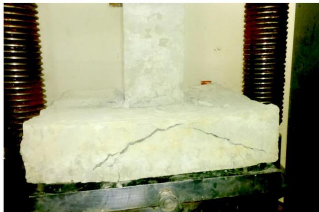
Fig. 7. Falla por cortante. Ensayo en la UNPRG. Lambayeque, Perú.
