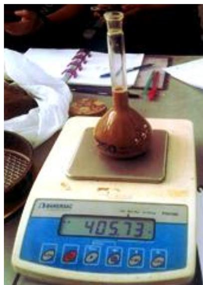
Fig. 19. Peso de fiola con suelo y agua destilada 1. El agua destilada se llena hasta una marca fija de la fiola.
