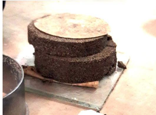
Fig. 8. Muestra de arena, con falla por cortante.
