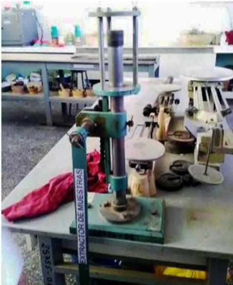
Fig. 6. Extractor de muestra, para sacar la muestra del molde (anillo) en que fue tallado.
