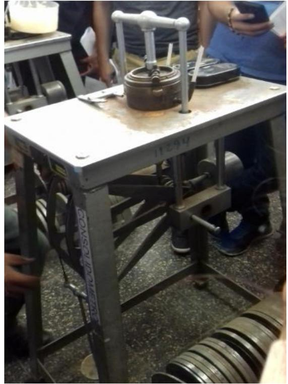
Fig. 8. La cazuela con la muestra, es colocada en una posición fija, luego un eje vertical encima, donde se transmite la carga vertical, que proviene de las pesas que se colocan debajo de la mesa..
