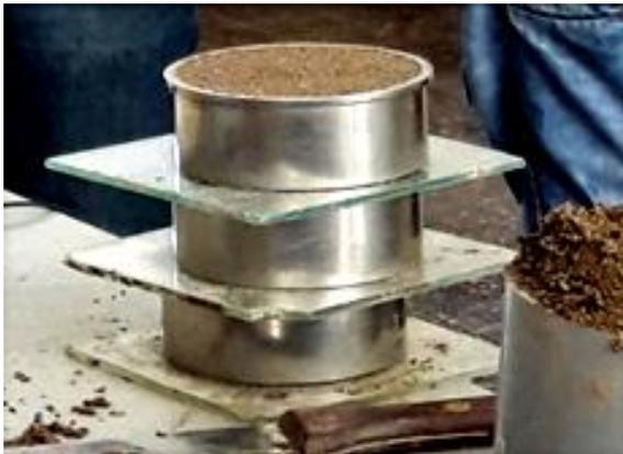
Fig. 6. Muestras talladas con sus anillos.
