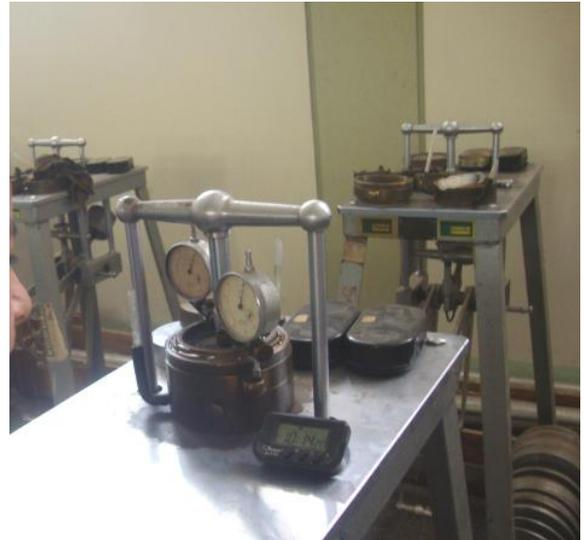
Fig. (1). Consolidómetro o edómetro
