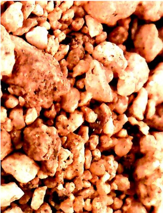
Fig. 38. Arena de la cantera "La Victoria" de Pátapo, Chiclayo, Perú, donde se aprecian partículas de diversos tamaños, mostrando una mejor gradación que la arena de la figura anterior.
