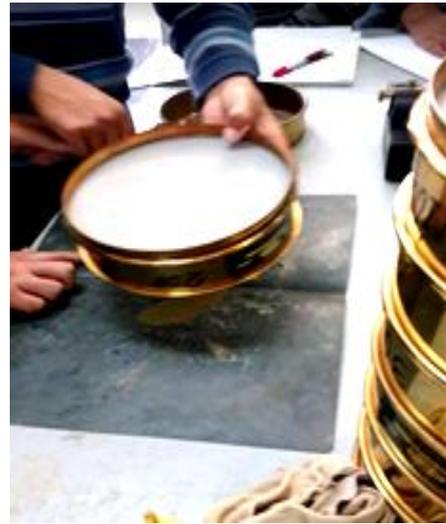
Fig. 26. Recuperación del material retenido en una malla, para luego ser pesado.
