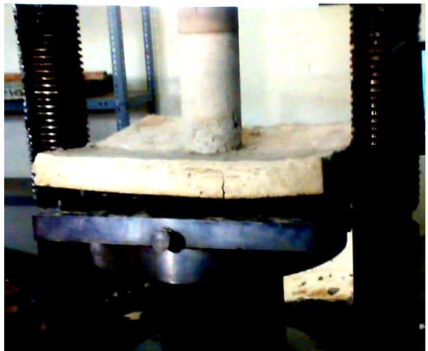
Fig. 12. Falla por flexión de zapata. Ensayo UNPRG. Perú. Se aprecia la flexión bidireccional, losa con curvatura doble..
