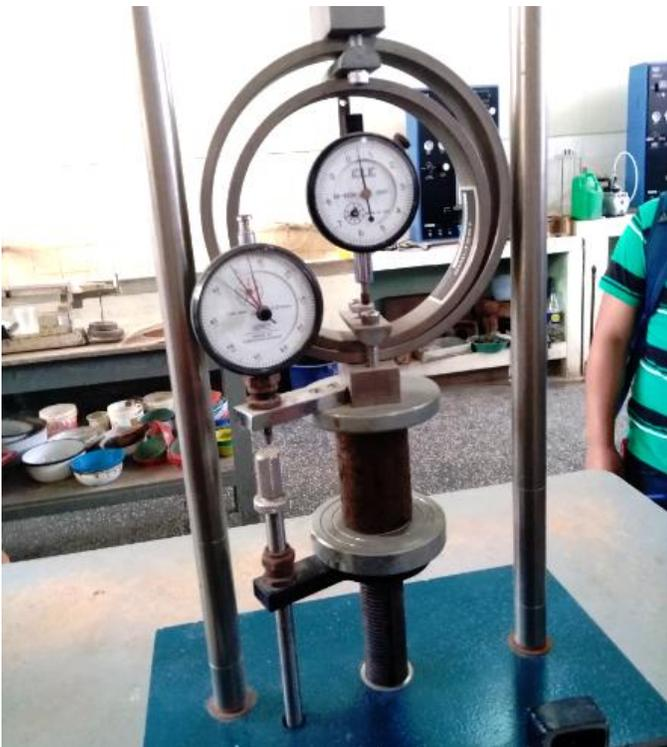
Fig. 8. El anillo de carga, con el micrómetro de carga, encima de la muestra. En primer plano el micrómetro de deformación.
