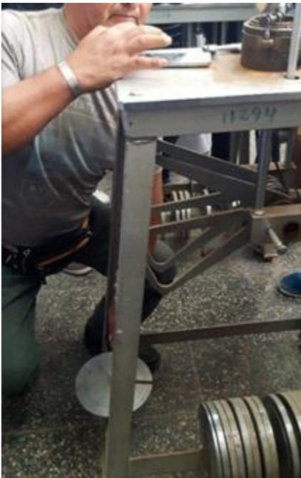
Fig. 11. Colocación de las pesas que se transmiten a la parte superior de la cazuela, a través del eje y mecanismo de cable y polea.
