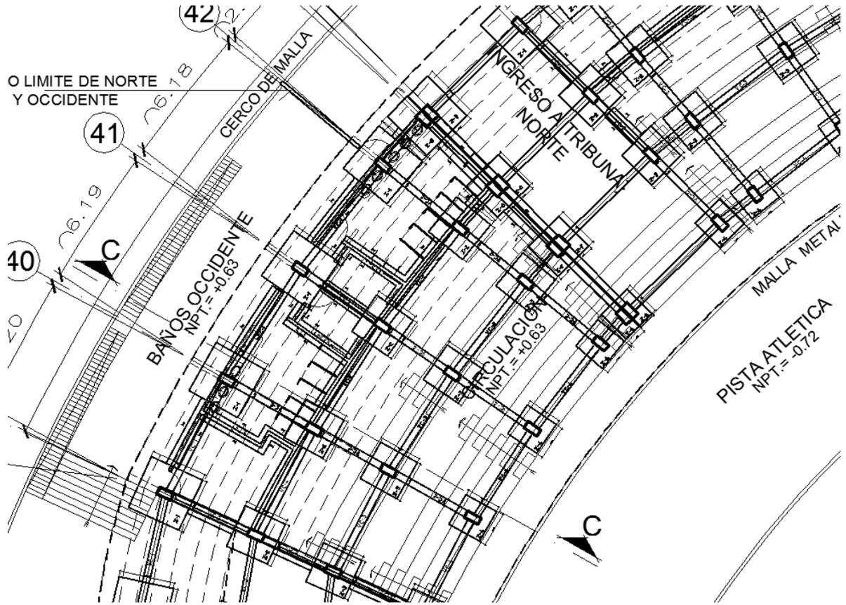
Vista parcial de planta de cimentación con zapatas conectadas.
