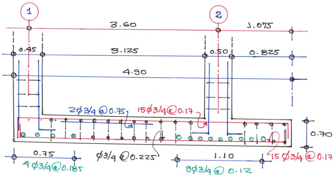
DETALLE DE REFUERZO LONGITUDINAL / TRANSVERSO
