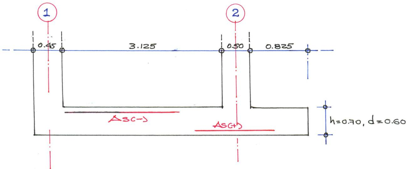
DISEÑO DE REFUERZO LONGITUDINAL:
