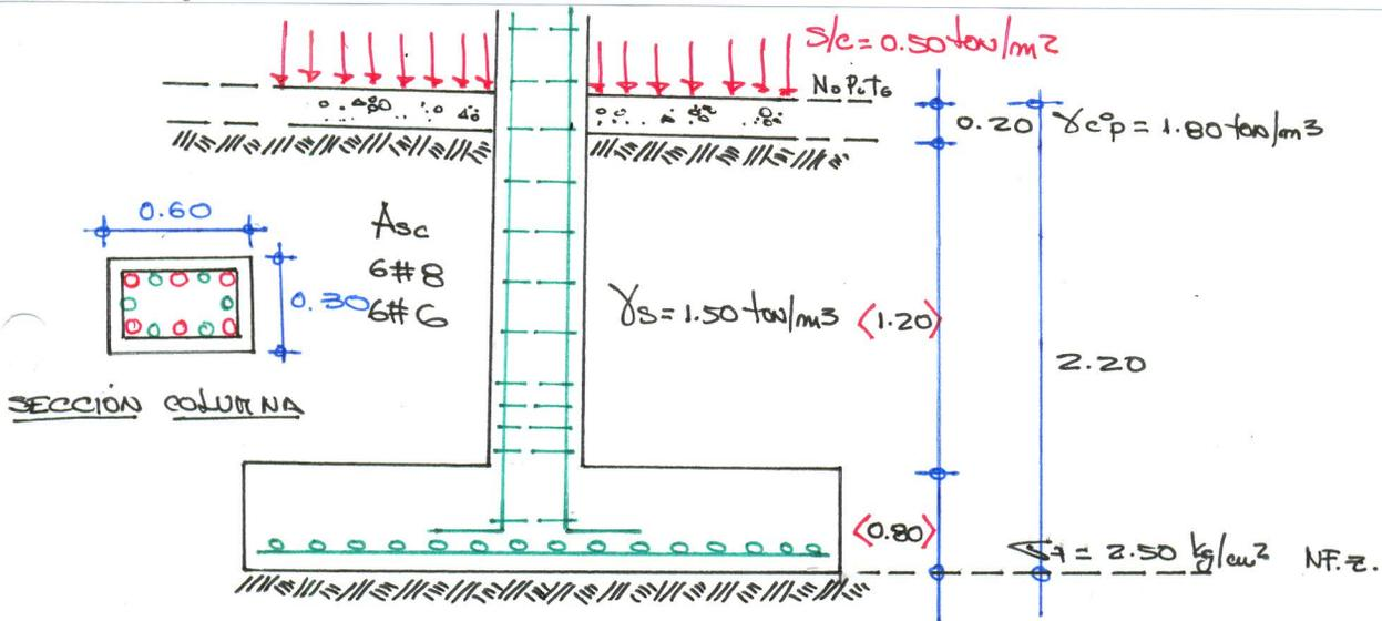
**⊕ DISEÑO Y VERIFICACIÓN DE LA ZAPATA :**
