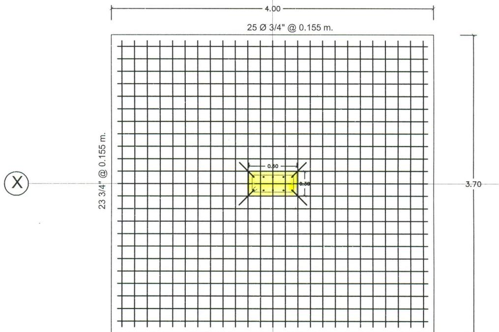
DETALLE DE ZAPATA EN PLANTA
