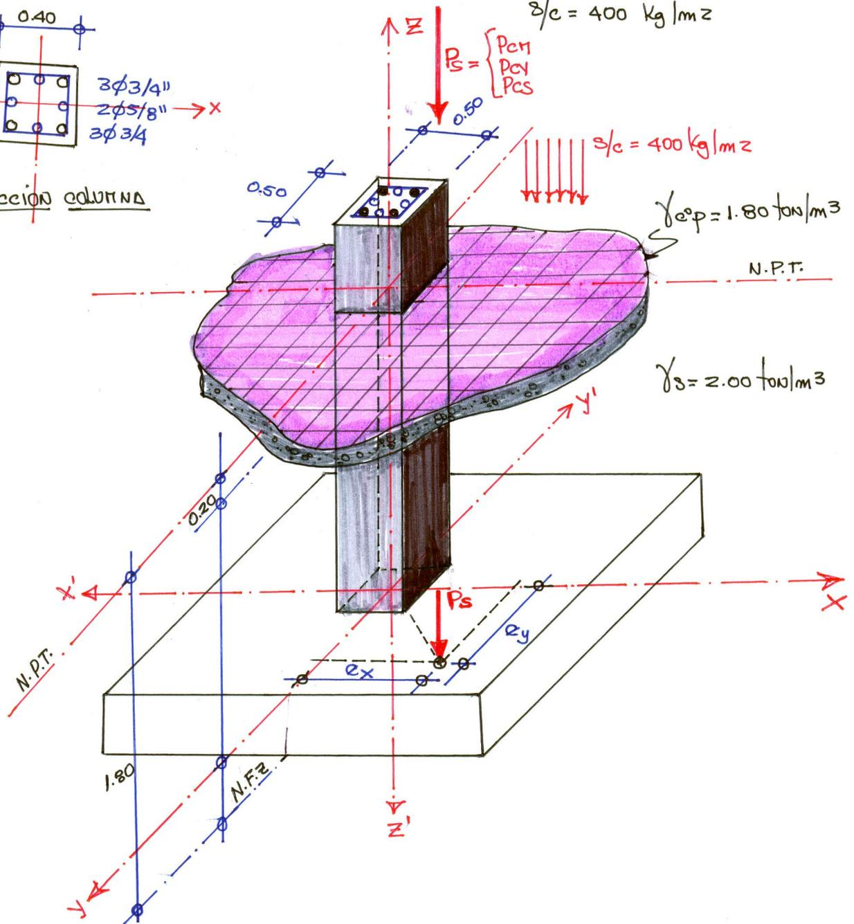
A: DIMENSIONAMIENTO DE LA ZAPATA
