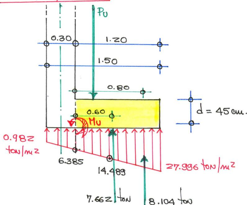
DISEÑO DE REFUERZO LONGITUDINAL
