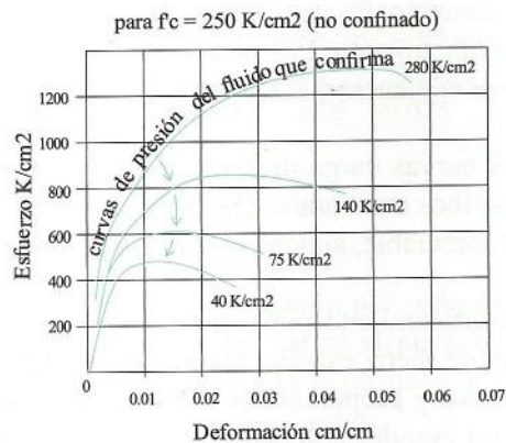
Fig. 1.8 Curvas Esfuerzo - Deformación Cilindros a compresión Triaxial
