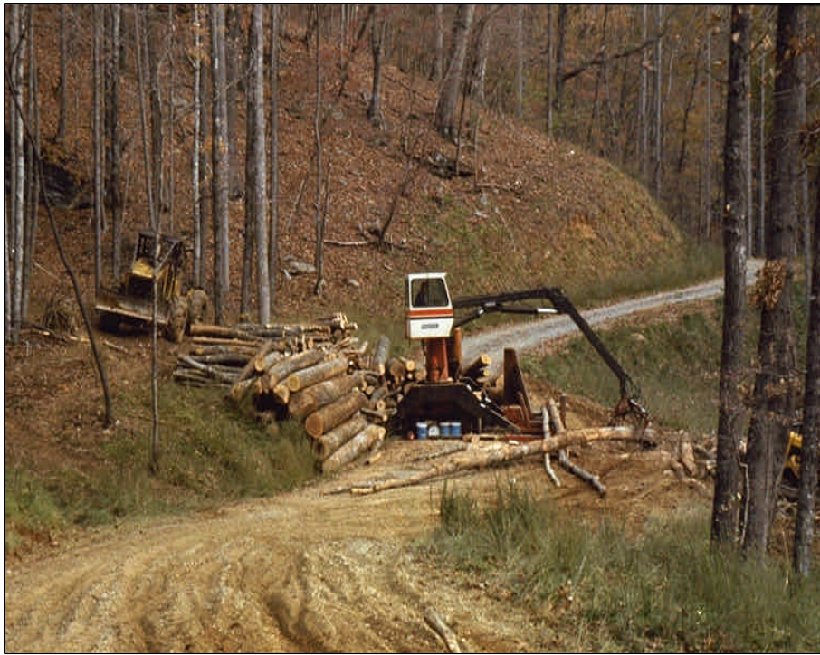
Foto 3.7 Ubique los caminos de arrastre de troncos y las plataformas de carga alejados de la ZPA y de las vías fluviales. Mantenga los caminos y las plataformas de carga pequeños y eficientes.
