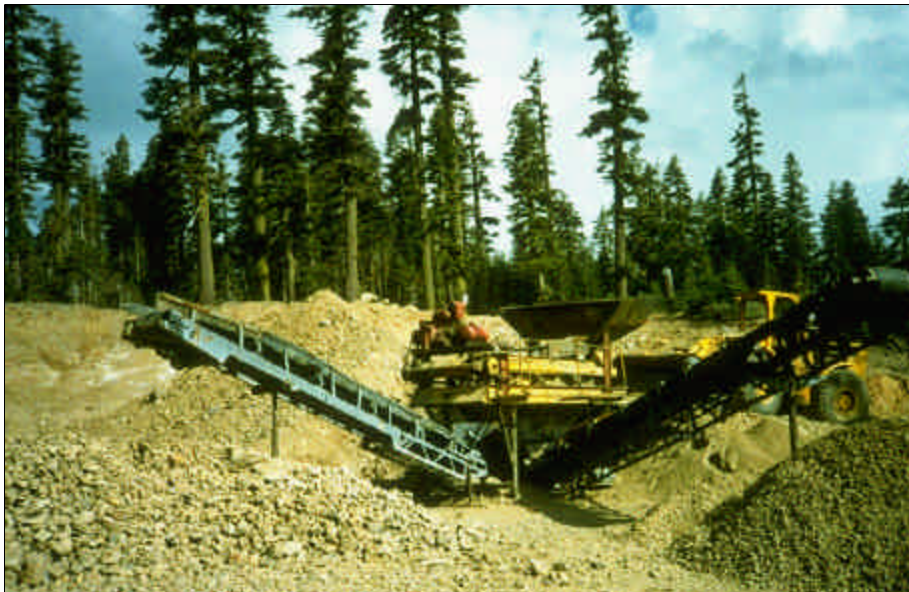
Foto 12.10 Las pedreras y bancos de préstamo pueden proporcionar un recurso excelente y relativamente barato como fuente de materiales para el proyecto. Un sitio de explotación puede sólo necesitar una excavación simple, cribado o triturado, para producir los materiales necesarios. Controle el uso de la zona con un Plan de Desarrollo de Bancos.
