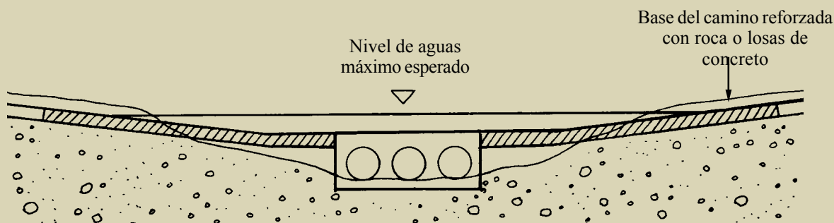
a. Cruce en estiaje simple con la base del camino reforzada con roca o concreto.
