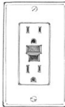
Los interruptores de circuito por falla a tierra (ICFT) y los diferenciales son necesarios allí donde pueda haber riesgo de electrocución, como, por ejemplo, cerca de un lavamanos. Cuando detectan una fuga de corriente, desconectan inmediatamente todo el circuito.
