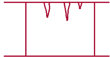
FALLA DE MUROM SIN VIGA SOLERA
